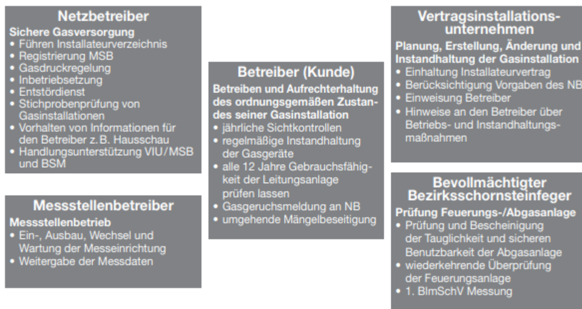
Abbildung 34: Übersicht Verantwortungsbereich der Rollen bei einer Gas-Feuerungsanlage; Quelle: Kommentar zum DVGW G 600 (TRGI) - Auflage 2020
